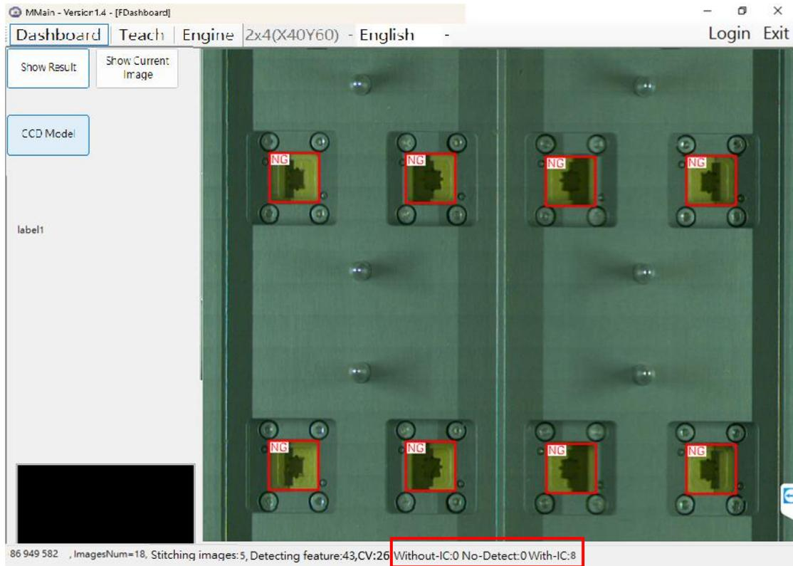
如果「Without-IC」跟 Socket-based 的數量不一致，調高色差，再移動馬達驗證結果。直到「Without-IC」跟 Socket-based 的數量一致為止。
