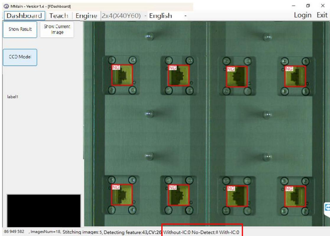
如果「Without-IC」跟 Socket-based 的數量不一致，調低匹配度，再移動馬達驗證結果。直到「Without-IC」跟 Socket-based 的數量一致為止。
